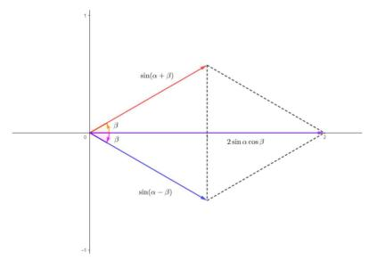
그림과 같이 기준각이  $\alpha$ 인 위상 평면에서  $\sin(\alpha+\beta)$ ,  $\sin(\alpha-\beta)$ 는 길이가 1인  $\sin\alpha$ 축 위상 자가 각각  $\beta$ ,  $-\beta$ 만큼 회전한 것이다. 따라서 이들을 합성한 보라색 위상자는  $\sin\alpha$ 축으로 길이가  $2\cos\beta$ 인 위상자이므로  $\sin(\alpha+\beta)+\sin(\alpha-\beta)=2\sin\alpha\cos\beta$ 이고 증명이 완료되었다.
